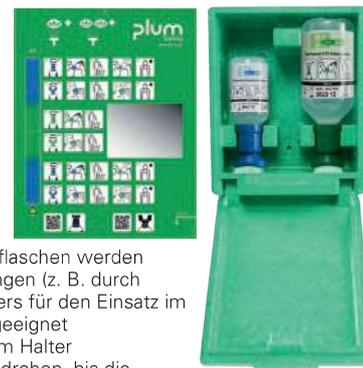
**Anwendung:** die Flasche aus dem Halter herausnehmen, die Augenschale drehen, bis die Versiegelung bricht, den Kopf zurücklehnen und spülen
