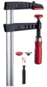
**Temperguss-Schraubzwinde Sicherheitszwinde · mit Abrutschsicherung im Schiebeteil** · Spannarme aus hochwertigem Temperguss · Gussteile blau pulverbeschichtet · verzinkte Hohlprofilschiene · beidseitig 3-fach geriffelt · bewegliche Stahldruckplatte · Trapezgewindespindel · Kunststoff-Schutzkappe und Kunststoffring am **ergonomischen Eschenholzheft**
