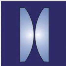
Apochromatische Linsensysteme verbinden die randscharfe Abbildung eines Aplanaten mit der Farbkorrektur eines Achromaten. Linsensysteme wie diese kommen in Messlupen zum Einsatz, bei denen nicht nur eine randscharfe Abbildung gefordert wird, sondern auch eine farbkorrigierte Abbildung sehr wichtig ist.
