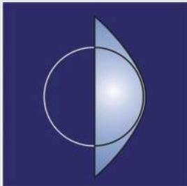
Ein aplanatisches Linsensystem besteht aus zwei plankonvexen Linsen und zeigt durch diese Anordnung eine randscharfe und verzerrungsfreie Abbildung. Es besteht aus zwei plankonvexen Linsen die mit ihrer gekrümmten (konvexen) Seite zueinander angeordnet sind. Gefertigt werden diese Plankonvexlinsen überwiegend aus Glas. Es kommen sphärische Linsen also Linsen mit nur einem Radius zum Einsatz.
